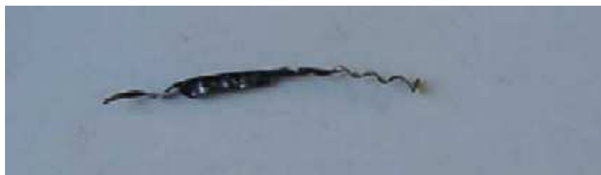
钻屑短而粗，正确
